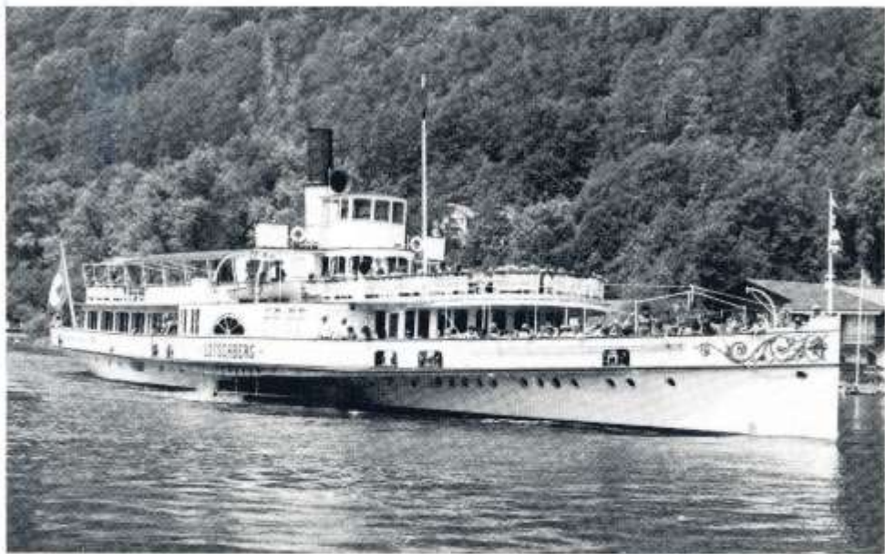
LÖTSCHBERG lämnar Interlaken för en tur ut på Brienzersjö. Byggt 1914, oljeeldad panna, tvåcylindrig compoundångmaskin om 450 hk, längd 53,5 m, bredd 6,8 m, 1100 passagerare. Hennes välputsade maskinrum torde vara en fröjd för alla ångentusiaster.
