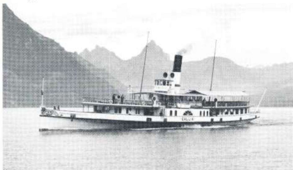
GALLIA på ingående till det lilla samhället Beckenried. Byggt 1913, oljeeldad panna, tvåcylindrig compoundångmaskin om 850 hk, längd 60,0 m, bredd 7,2 m, 1100 passagerare. Hon sägs vara den snabbaste av de schweiziska insjöångarna, varför hon är insatt på den långa traden till Fluelen två gånger dagligen.
